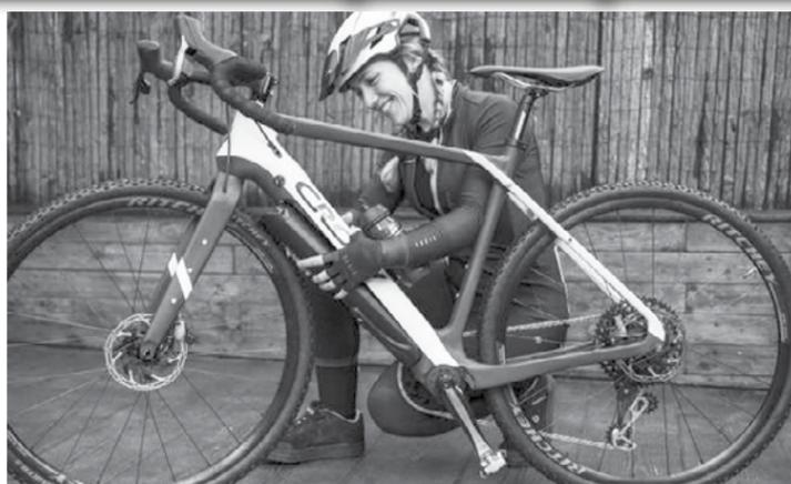
est entièrement en carbone, des roues jusqu'au guidon en passant par la tige de selle et bien évidemment le cadre. Le groupe motopropulseur est un Fazua Evation, une solution qui intègre la batterie 250 Wh et un moteur électrique dans un module détachable qui vient s'insérer dans le tube inférieur et se connecte à un engrenage dans le pédalier. Il
