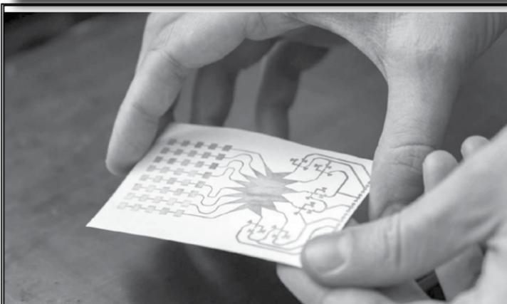
Des chercheurs américains ont mis au point une antenne redresseuse révolutionnaire, capable d'alimenter de petits appareils électroniques grâce aux ondes millimétriques du réseau 5G. Cette invention pourrait transformer le réseau mobile en réseau électrique sans fil pour l'Internet des objets.
