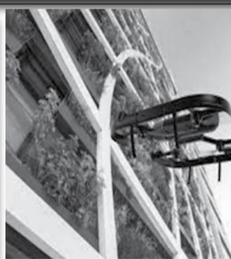
et tout enregistrer sous la forme d'un nuage de points. Le drone est également équipé du radar, de cinq caméras, pour déterminer la couleur de ces points, et d'un système de positionnement GNSS. Les données sont enregistrées sur la plateforme HxDR d'Hexagon et peuvent ainsi être facilement traitées et partagées.
