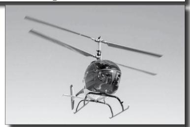
d'oxygène sera aussi disponible. Avec ce CoAX-2D modifié, PiAC souhaite réaliser un prototype fonctionnel qui pourrait l'aider à concevoir son propre hélicoptère à hydrogène, le PA-890. Un appareil plus gros, pouvant emporter plus de deux passagers. Les premiers
