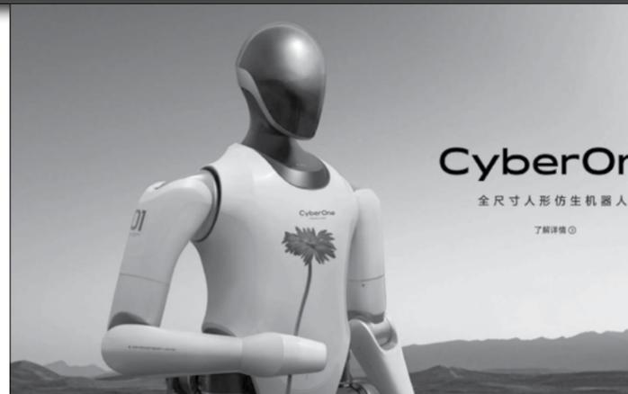
Pour réaliser ses mouvements, son corps est composé de 13 articulations qui lui confèrent une amplitude de 21°. Les membres peuvent réagir en moins de 0,5 m/s et ses mains ont une précision de couple pouvant aller jusqu'à 1 Nm pour pouvoir toucher doucement un élément. Globalement, le robot reste un peu pataud, il
