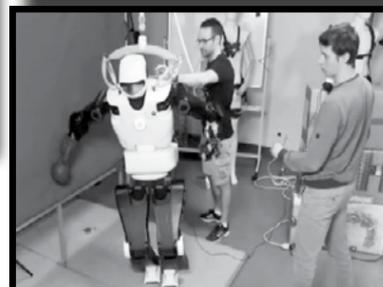
Des chercheurs ont doté un robot d'un réflexe qui lui évite de tomber en cas de panne. Grâce à un réseau neuronal entraîné dans des simulations, il calcule comment s'appuyer sur un mur pour conserver l'équilibre et éviter des dommages qui peuvent coûter cher.
