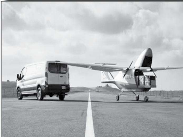
Pratique, fonctionnel, voici le tout premier avion-cargo électrique et véhicule autonome au monde. Le Pelican Cargo se charge par l'avant avec un plateau coulissant ; Pyka, son constructeur espère améliorer les réseaux logistiques express, faciliter l'accès dans
