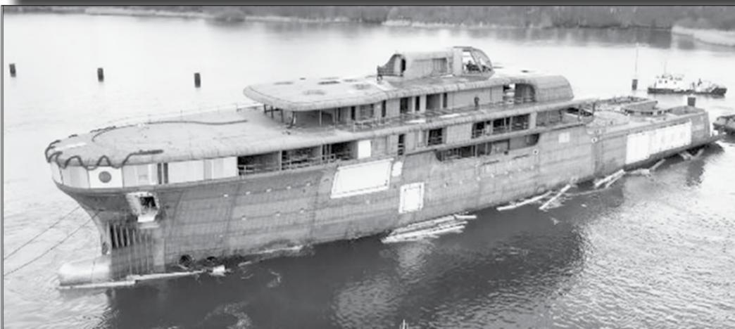
Construit par la société allemande Lürssen Yachts, le navire sera équipé de piles à hydrogène, mais utilisera une méthode particulière pour stocker le carburant.
