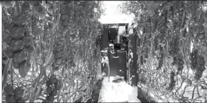
Greenhouse Robotic Worker, comprenez Ouvrier robotique de serre — et destiné à évoluer sous des serres high-tech pour cueillir des fruits et des légumes. À l'origine, surtout des tomates. Il est équipé d'un système de vision 3D avancée, relié à une intelligence artificielle pour s'assurer que ne soient cueillies
