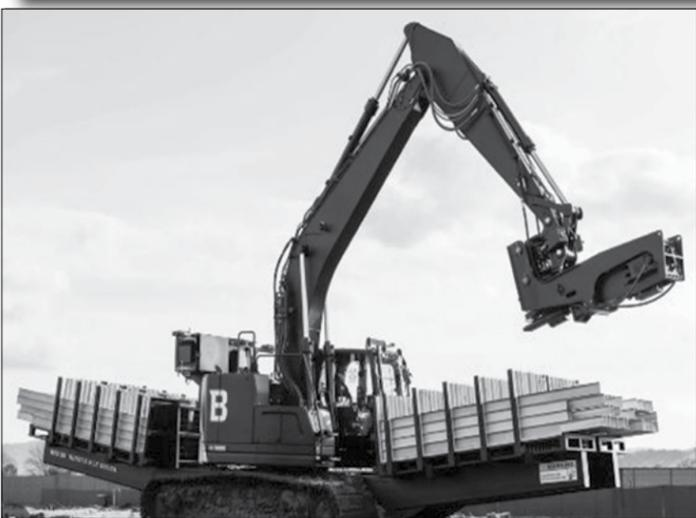
Voici RPD 35, une excavatrice guidée par intelligence artificielle pour accélérer la construction des fermes solaires. Elle s'occupe de manière autonome d'une des tâches les plus intensives physiquement, le battage des pieux. Combinés à l'intelligence artificielle, les robots pourraient révolutionner de nombreux secteurs en s'occupant des tâches les plus ingrates, permettant aux humains de se concentrer sur le reste. C'est ce que propose l'entreprise Built Robotics.
