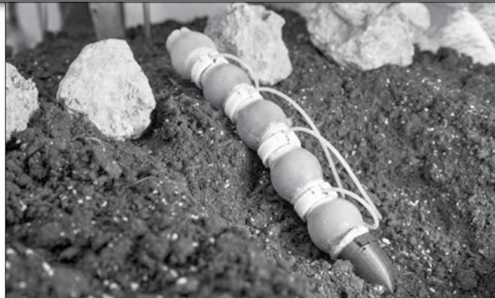
circulaires sous la tête. Cela crée le corps du robot en forme de tube, avec le filament qui arrive au milieu, poussant la tête vers l'avant. La tête du robot contient un ensemble de capteurs qui lui
