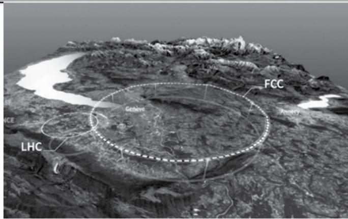
les équipements d'expériences, placés le long de l'accélérateur. Le démarrage des travaux est prévu pour 2033, avec un tunnel de 5,5 mètres de diamètre, passant à trente mètres sous le lit du Rhône, au moins cent mètres sous le lac Léman, et jusqu'à plus de 500 mètres sous le plateau de la Borne, dans les Préalpes.
