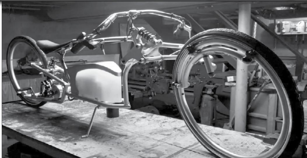
maintenir les roues en place sans moyeu, trois rouleaux en nylon sont encastrés dans la jante. À l'arrière, trois autres permettent d'entraîner la roue par friction. C'est un moteur central de 2 000
