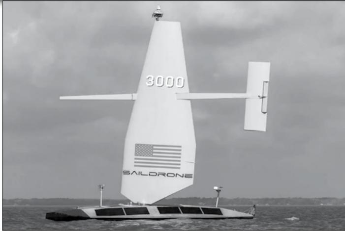
version du Surveyor que Saildrone vient d'annoncer, le SD-3000. Le drone a la particularité d'avoir une coque en aluminium, contrairement aux précédents modèles en un composite de fibre de verre et carbone. L'aluminium a été choisi pour sa robustesse et sa durabilité dans l'environnement marin, et surtout parce qu'il est possible de produire les pièces
