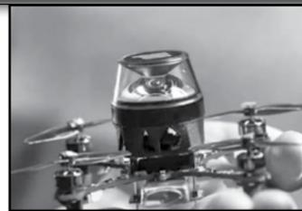
grand sur un cliché que ce que la caméra voit, cela signifie que le drone doit se rapprocher de l'objet jusqu'à ce que les images correspondent exactement. Lors des tests, le micro drone des chercheurs a pu naviguer de manière autonome et efficace pour retrouver son chemin dans un parcours d'obstacles d'une centaine de mètres. Pour cela, seulement 1,16 Ko de mémoire a été utilisé. Cela en fait le plus petit drone autonome.
