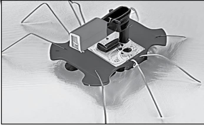
»inscrivent dans un programme de la Darpa datant de 2017. Baptisé « Océan des objets », il consiste à créer des micro-capteurs flottants autonomes en énergie et permettant de collecter des données environnementales (température de l'eau, localisation, trafic maritime, détection de la faune marine...). Comme il s'agit de l'agence de recherche militaire, les données pourraient également servir à des missions répondant aux besoins de l'armée américaine. Le robot de ces chercheurs est alimenté
