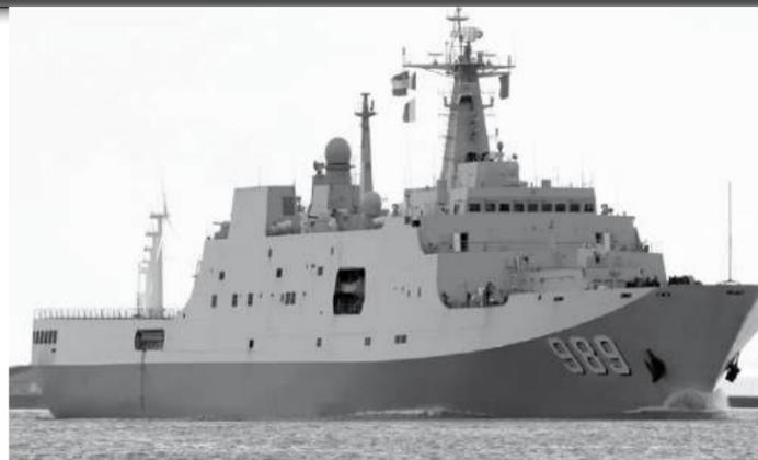
barre sur les autres navires de guerre. Le canon laser a été placé à l'arrière d'un canon de 76 mm à double usage, situé sur la proue du navire. Le type 071 est un Landing Platform Dock capable de transporter jusqu'à 800 soldats, six hélicoptères lourds Z-18 (deux sur le pont et quatre dans le hangar), quatre aéroglisseurs type 726 et 20 véhicules de combat amphibies.
