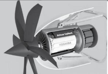
de circuler sans résistance, et donc sans créer de perte sous forme de chaleur. Dans le moteur en développement par les deux entreprises, les bobines du stator et du rotor seront composées d>un matériau supraconducteur. Le combustible en question serait de l'hydrogène, refroidi à -253 °C, qui servirait également à refroidir les systèmes de propulsion via une boucle de recirculation à l>hélium. Cela augmenterait l>efficacité du moteur tout en réduisant son
