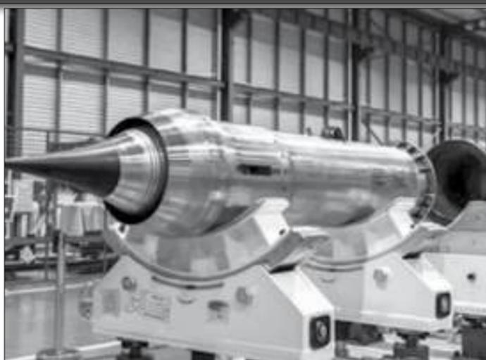
caractéristiques, le JinDou400 mesurerait environ trois mètres de long pour 30 centimètres de diamètre. Sa poussée serait 400 kgf (kilogramme-force). Par la suite, le moteur devrait donc être embarqué dans un jet supersonique, appelé Yunxing.
