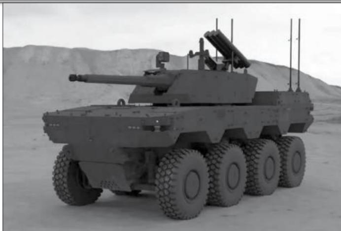
étant à la fois rapide, léger et très maniable. Avec ses huit roues à traction indépendantes, il peut tourner sur lui-même à 360°. Son autre atout : il repose sur une plateforme qui lui permet de remplacer son canon de 30 mm par une tourelle sur laquelle se trouvent des tubes lance-missiles ou encore des systèmes de défense antiaérienne.
