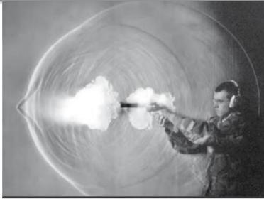
l'indice de réfraction de l'air, les petites modifications de pression atmosphérique, de température et de densité de l'air deviennent alors visibles avec cette méthode. Voir l'invisible
