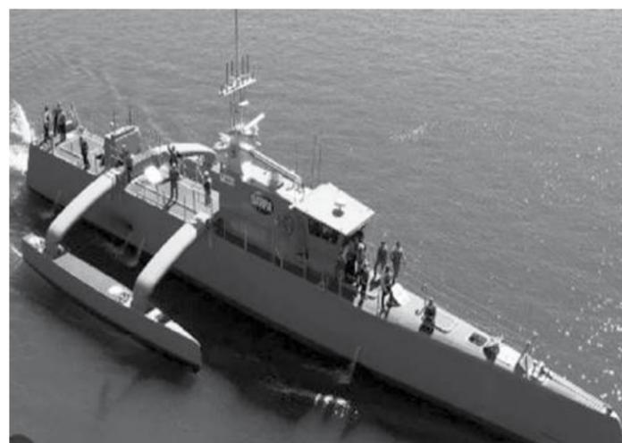
de limite en matière d'autonomie. Ainsi, ce grand drone naval à allure acérée est conçu pour pouvoir opérer en mer de façon totalement autonome pendant des mois, sans ravitaillement. Il serait capable de naviguer
