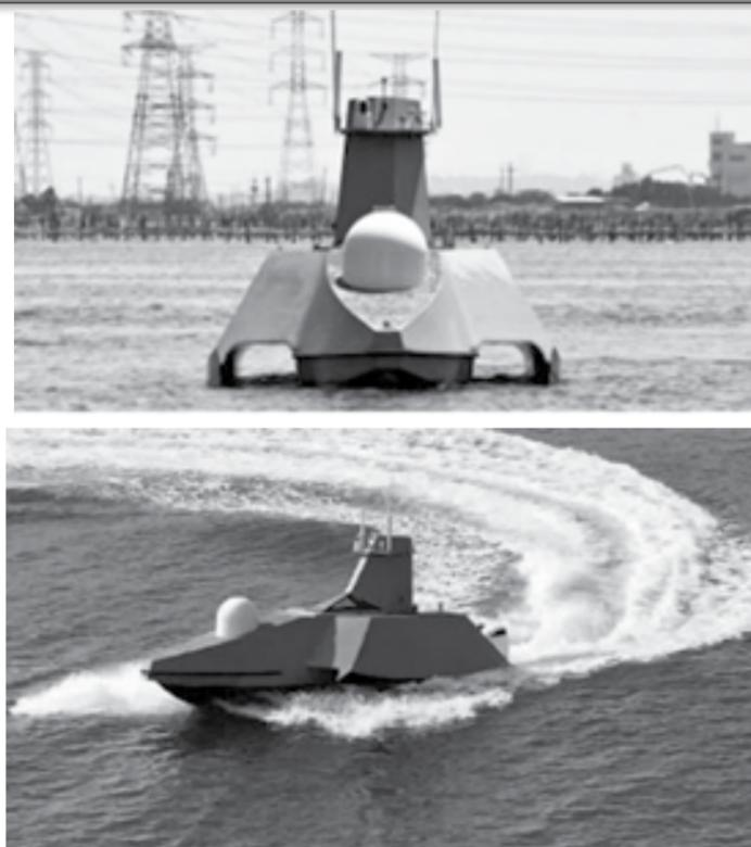
sur 3,7 mètres et de cinq tonnes. Fabriqué en plastique renforcé de fibres, il est annoncé comme low-cost, donc pouvant être produit en masse rapidement. L'engin peut embarquer une tonne de charge utile, dont des explosifs sur sa proue et des
