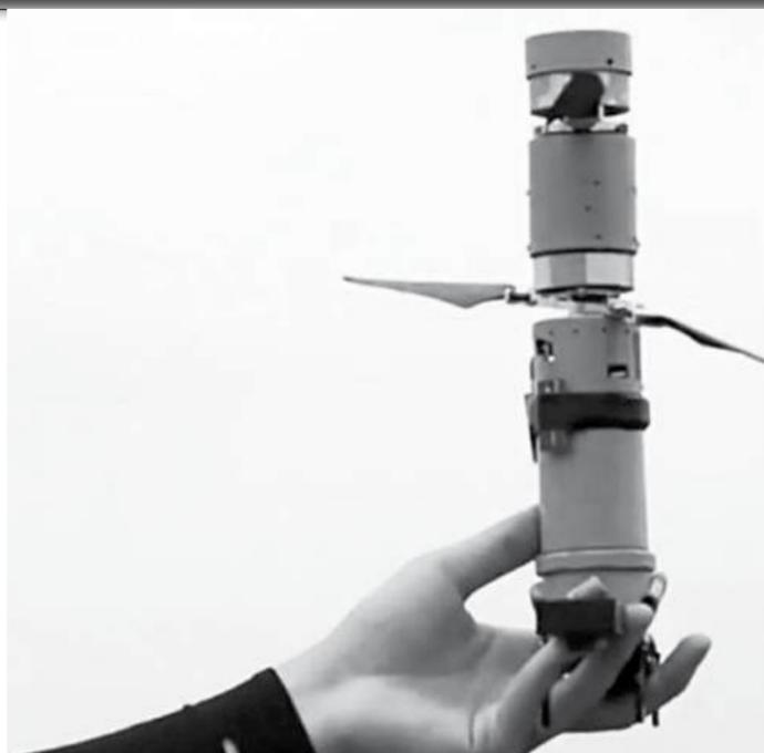
tube vertical doté de deux étages de rotors contrarotatifs. Une architecture assez inédite, puisque les seuls modèles militarisés existants ayant cette forme sont équipés d'au moins quatre petits bras et autant de rotors, à l'instar du Drone40 de DefendTex. Tout comme ce dernier, le drone chinois peut être lancé à partir d'un lance-
