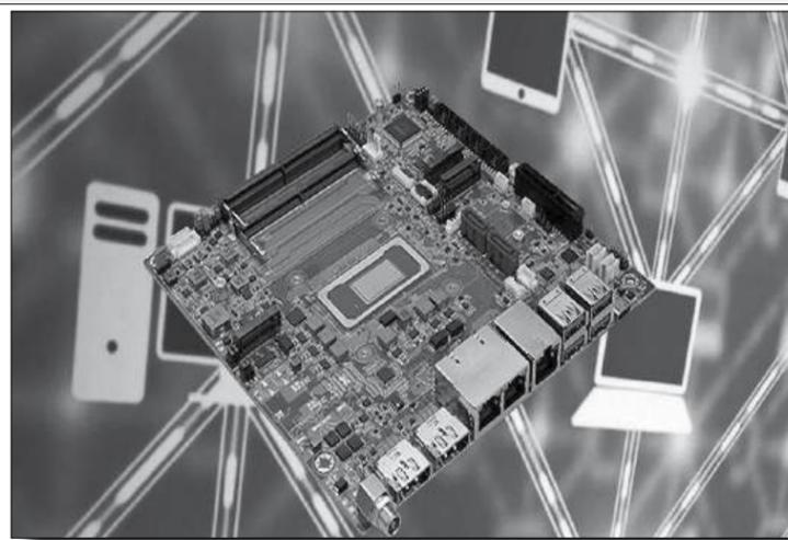
USB-C, 1x M2A-Display extension port), mais aussi de cinq ports M.2. Le premier est câblé en PCIe Gen 5 x4, le second en M.2 Key A (NVMe), le troisième en M.2 Key B (4G/5G), le quatrième en M.2 Key E (Wi-Fi/Bluetooth) et le dernier en M.2 Key A (M2A-Display et USB extension). Enfin, jusqu'à 3 ports RJ45 2,5 GbE composent l'interface réseau, tandis que 2 ports COM, 4 USB-A 3.2
