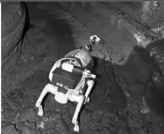
Pour les besoins de cette exploration, les « Fourmilier » et « Salamandre », possèdent chacun des caractéristiques et des rôles différents. Le premier est équipé d'un bras robotique flexible. Le « Salamandre », quant à lui, s'inspire de la mobilité flexible de l'amphibien. Le robot est doté de roues souples et déformables pour se faufiler dans ce qu'il y a de plus étroit et sinueux. Selon l'équipe
