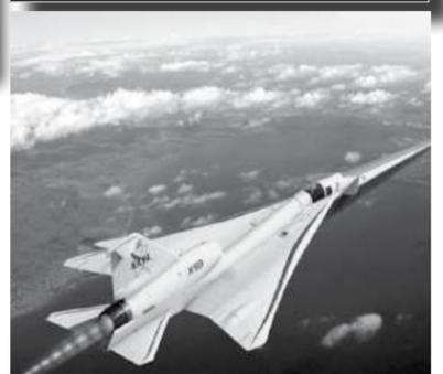
**Le X-59 QueSST, avion expérimental conçu par la Nasa et Lockheed Martin, a effectué son premier vol d'essai. L'appareil doit démontrer qu'il est possible de franchir le mur du son sans provoquer de bangs supersoniques**
