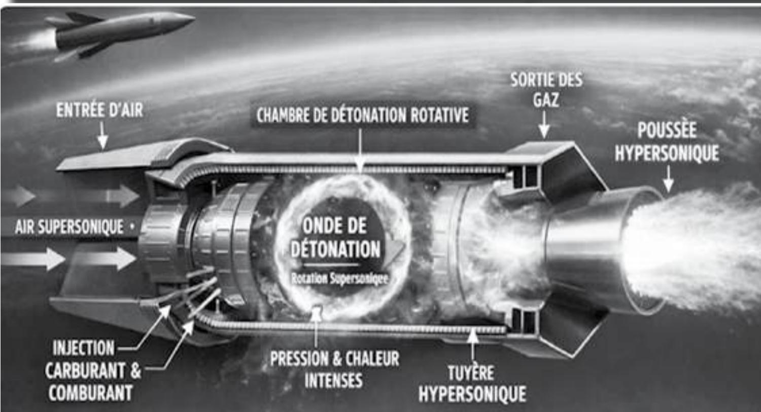
Pour répondre aux besoins de l'armée américaine, GE Aerospace et Lockheed Martin développent un statoréacteur à détonation rotative. La technologie permet de propulser plus efficacement et de manière fiable les missiles hypersoniques. Compact, léger, pratiquement dénué de pièces mobiles, il promet une poussée plus efficace pour des missiles plus rapides, plus maniables et facilement industrialisables.
